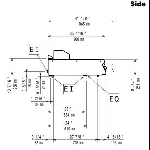
**EI** = Electrical inlet (power) **EQ** = Equipotential screw
