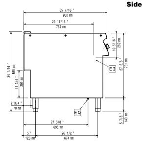
Electrical inlet (power) Equipotential screw
