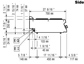
Electrical inlet (power) EQ Equipotential screw
