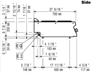
**EI** = Electrical inlet (power) Equipotential screw
