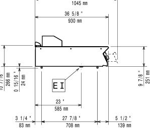
Electrical inlet (power) Equipotential screw
